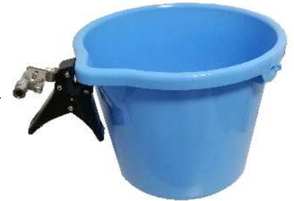
スプリングクリップバイブ使用例 (ポリバケツ)
