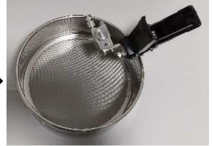
スプリングクリップバイブ使用例 (φ200ふるい)
