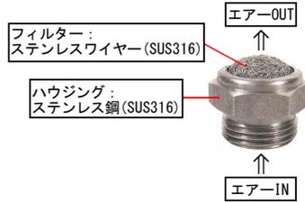
超小型ながら、樹脂製や焼結メタル製サイレンサーと比較して圧力損失が圧倒的に少なく、エア排気ポートからの異物侵入防止用フィルターと消音用を兼ね備えたサイレンサーです。金属製サイレンサーの場合は、一般的にフィルターエレメントに使われる焼結金属はメッシュが細かいため、ゴミ等による目詰まりにより流量性能が徐々に失われ、ついにはエア機器やエアバイブレーター等の機能不全が起きます。
